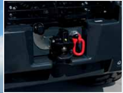
Automatikkupplung mit 13-poliger Steckdose (Option)
