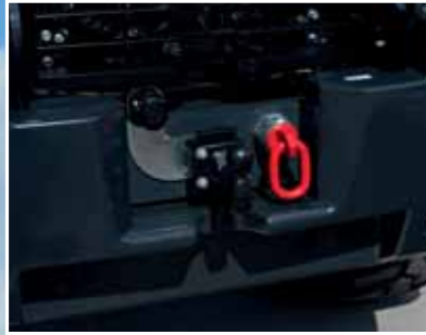
Kugelkopfkupplung mit 13-poliger Steckdose (Option)
