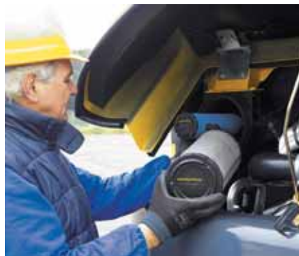
Hinterere Wartungsklappe für schnelle Motorinspektion und einfachen Zugang zu allen vom Boden aus zu erreichenden Wartungspunkten
