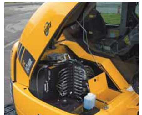
Rechte Wartungsklappe ermöglicht einfachen Zugang zu Hauptsteuerblock, Kraftstofftank, Öltank und Werkzeugkasten
