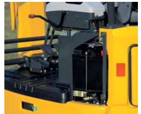
Linke Wartungsklappe: leichter Zugang zur Batterie
