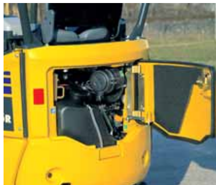
Hintere Wartungsklappe: schnelle Motorinspektion und Betankung
