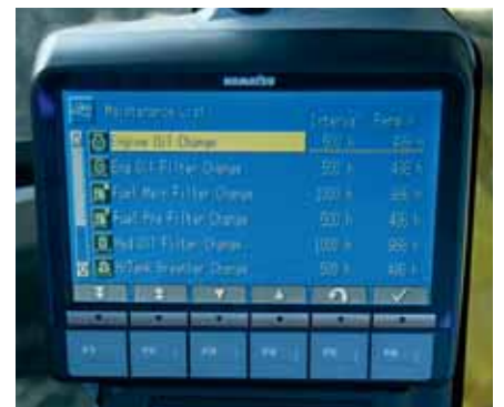
Der LCD-Monitor zeigt Unregelmäßigkeiten und Wartungsintervalle an
