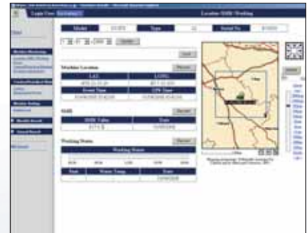
Gesteigerte Sicherheit – Mit Hilfe der Motorsperrfunktion lässt sich festlegen, in welchen Zeiträumen die Maschine gestartet werden kann. Die Geofence-Funktion benachrichtigt den Maschinenbesitzer, sobald die Maschine einen festgelegten Einsatzbereich verlässt.
