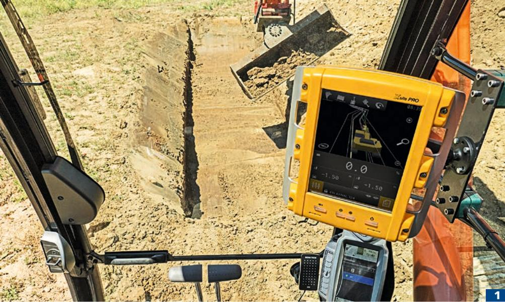
1 Auf dem Display kann man das selbst einprogrammierte 3D-Geländemodell im Längs- oder Querprofil sehen.
